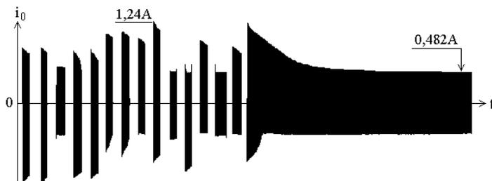
Рисунок 6 – Осциллограмма многократного включения экспериментального трансформатора в сеть в режиме нагрузки
